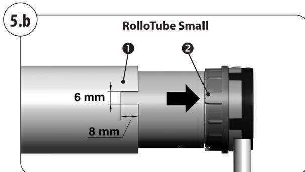
2. Sägen Sie am Ende des Präzisionsrohrs eine Nut ① aus, damit der Nocken ② des Adapters ganz in das Rohr geschoben werden kann.
