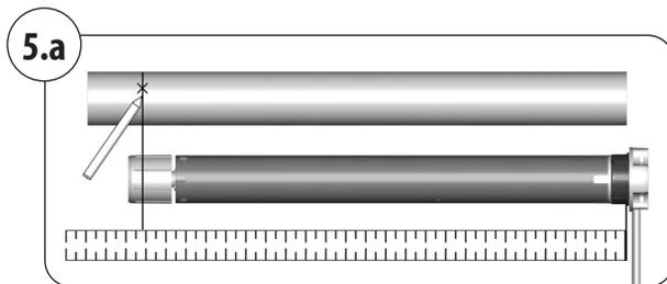
1. Messen Sie den Abstand zwischen Adapter und dem hinteren Drittel des Mitnehmers und zeichnen Sie diesen Abstand auf das Präzisionsrohr.
