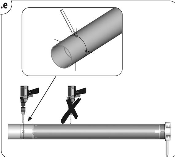
4. Markieren Sie vier Befestigungslöcher und bohren Sie diese anschließend durch das Präzisionsrohr in den Mitnehmer.
