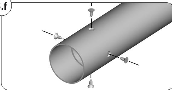
5. Das Präzisionsrohr am Mitnehmer festschrauben oder vernieten.
