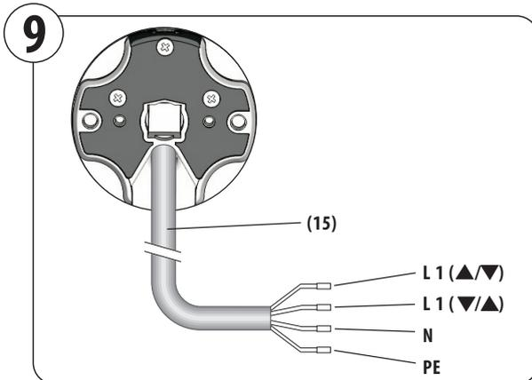
1. Führen Sie das Motorkabel (15) nach dem Einhängen des Motors in die dafür vorgesehene Abzweig- oder Schalterdose.
