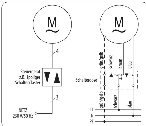
Installationsplan und Anschlussplan für die Montage an der rechten Seite..
