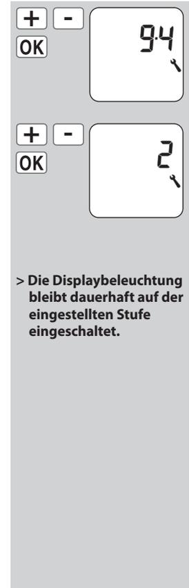
> Die Displaybeleuchtung bleibt dauerhaft auf der eingestellten Stufe eingeschaltet.
