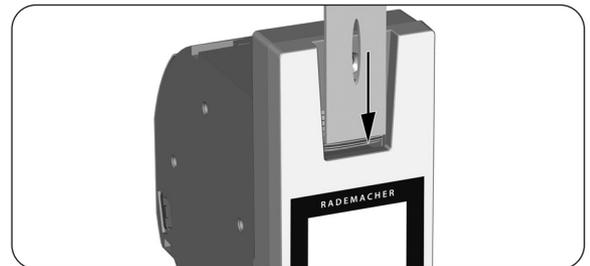
5. Führen Sie das Gurtband im Gerät weiter, wie rechts in der Schnittdarstellung gezeigt und schieben Sie anschließend das Gurtband von oben über den Befestigungshaken.
