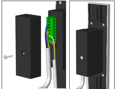
1. Hebeln Sie zuerst die Frontblende vorsichtig ab und schieben Sie die Modi Gurtkastenuhr anschließend in den Gurtkasten.
