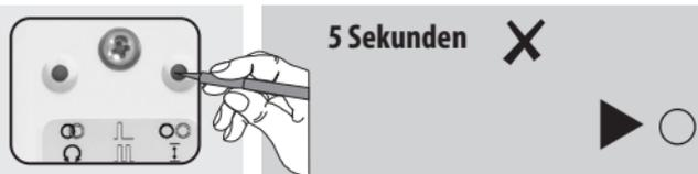
**Die „Trennen-Taste“ ca. 5 Sekunden gedrückt halten, bis die Status-LED rot blinkt.**
