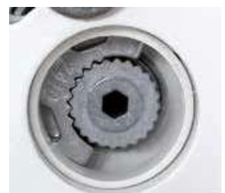
Bild 3: Die Verzahnung ist durch das Anziehen der Feststellschraube fixiert.
