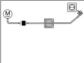
Die Inbetriebnahme kann mit der Schaltergarnitur (Art.-Nr. 4901 001 158 0) oder dem vorgesehenen Bedienelement erfolgen.
